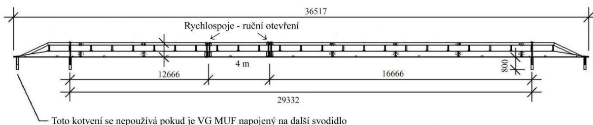
Výkres 2 – spoje s uzavřenými profily pro rychlé otevření
